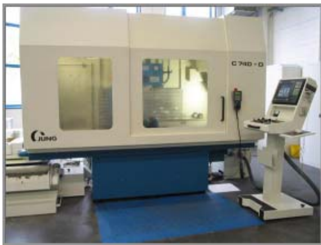
2. ábra. A C740 típusú CNC-vezérlésű sík- és profilkőszörűgép
