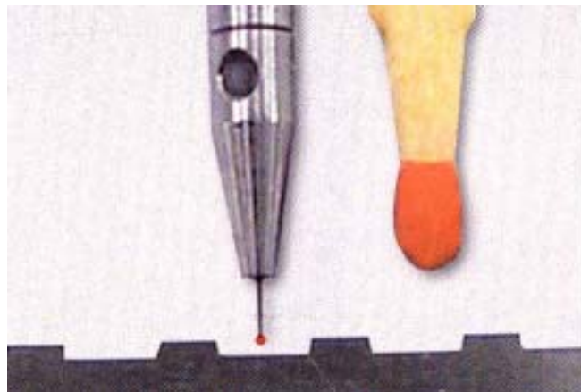
3. ábra. Integrált mérési ciklusok akár \varnothing 0,3 mm mérőfejjel
