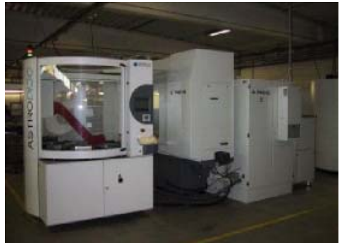
6. ábra. A C740 típusú köszörűgép automatizálása munkadarab-adagoló egységgel
