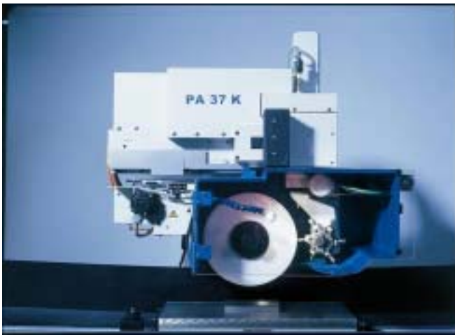
4. ábra. A PA37K CNC-vezérlésű, köszörűfejen elhelyezett kölelő egység
