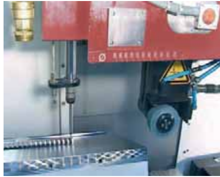
Messtaster, in den Arbeitsraum einfahrbar. Bis 2 1/2 Achsen und einer Messgenauigkeit von +/- 1 µm und Schleif-einrichtung für kleine Schleifscheiben (Ø 50... 100 mm)
