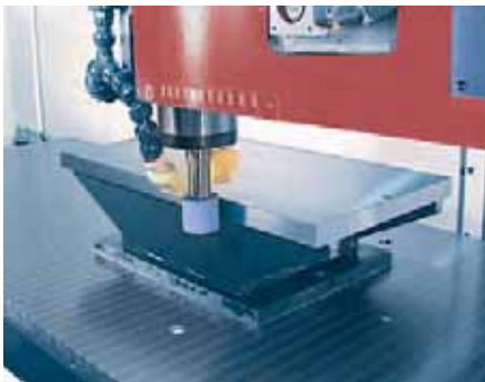
Vertikal-Zusatz-Schleifspindel, verschiebbar; 5 kW, max. 30.000 min -1
