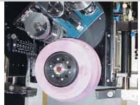
Abrichtgerät PEA-K auf dem Schleifkopf für CD- und IPD-Schleifverfahren, Doppelspindelausführung
