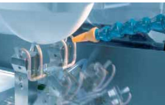
Klappbarer Doppel-Tischabrichter zur Aufnahme von 4 Profildiamanten
