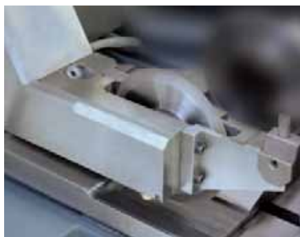
Auf dem Maschinentisch montiertes Abrichtgerät PA130TM zum Profilieren der Schleifscheiben mittels der Maschinenachsen und einer CNC-gesteuerten Schwenkachse
