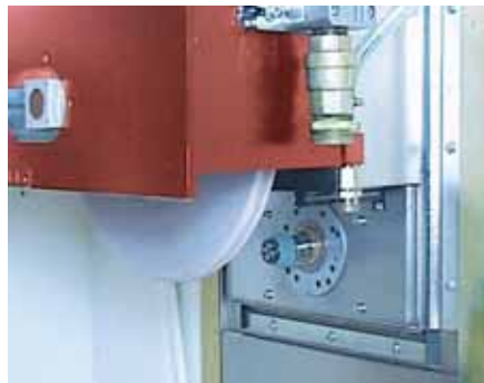
Horizontal-Zusatzspindel, automatisch in den Arbeitsbereich einfahrbar. Min. Schleifscheiben Ø 30 mm zum Hinterschleifen von Räumadeln
