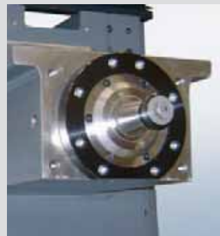
Einschubspindel mit 4-fach Lagerung
