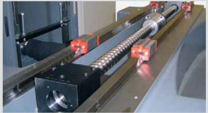
Präzisionsführungen und hochwertige, geschliffene Kugelgewindetriebe in allen Achsen
