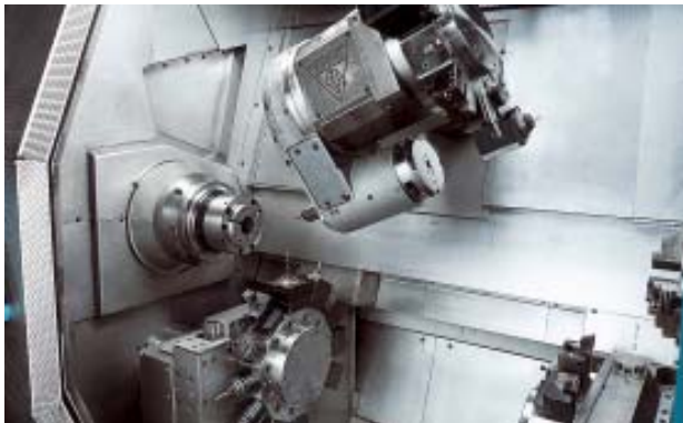
1. ábra. Szerszámhordozó multifunkciós maróorsóval, Y és B tengellyel
