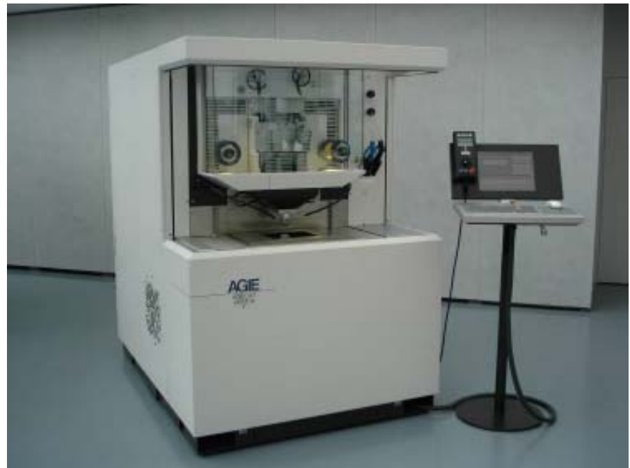
3. ábra. AGIECUT Vertex, a cég legpontosabb huzalos szikraforgácsoló berendezése
