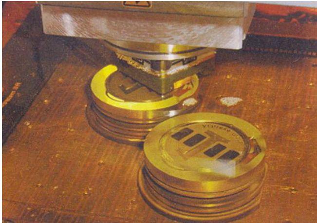
3. ábra. A tömbelektrodás szikraforgácsolás 3 tengelyel történik, kiegészíthető egy forgó C-tengellyel A technológiák összehasonlítása
