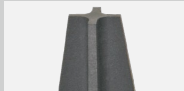
Unbenutzte Elektrode auf HSM 300 HSC gefräst
