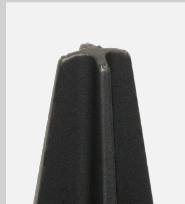
Erodiert auf FORM 200/300 ohne iQ-Technologie, Technologiestand gestern
