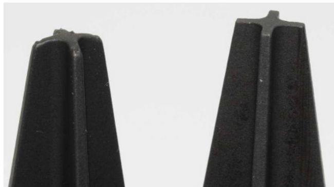
3. ábra. Azonos grafitelektródák hagyományos (bal oldali) és iQ-technológiával (jobb oldali) történt megmunkálás után
